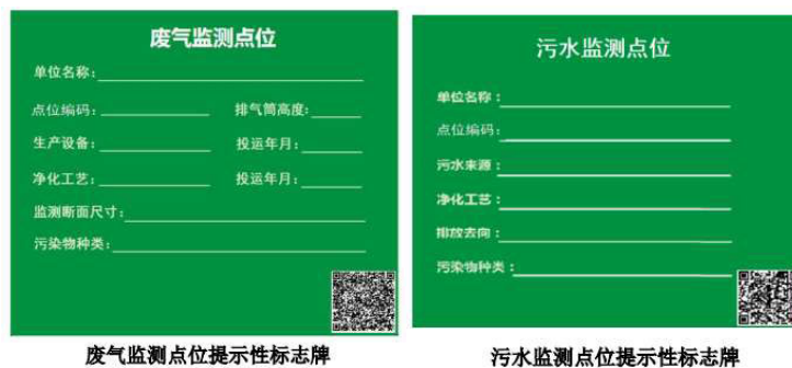
图 5-2 废水、废气监测点位标志牌设置示意图
